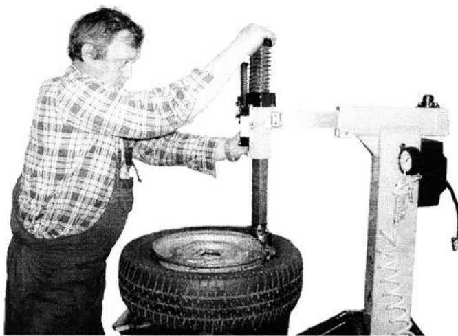
Nr. 8 placering af glider og monteringshoved
