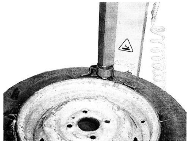
Nr. 9. Monteringshoved klar til brug
